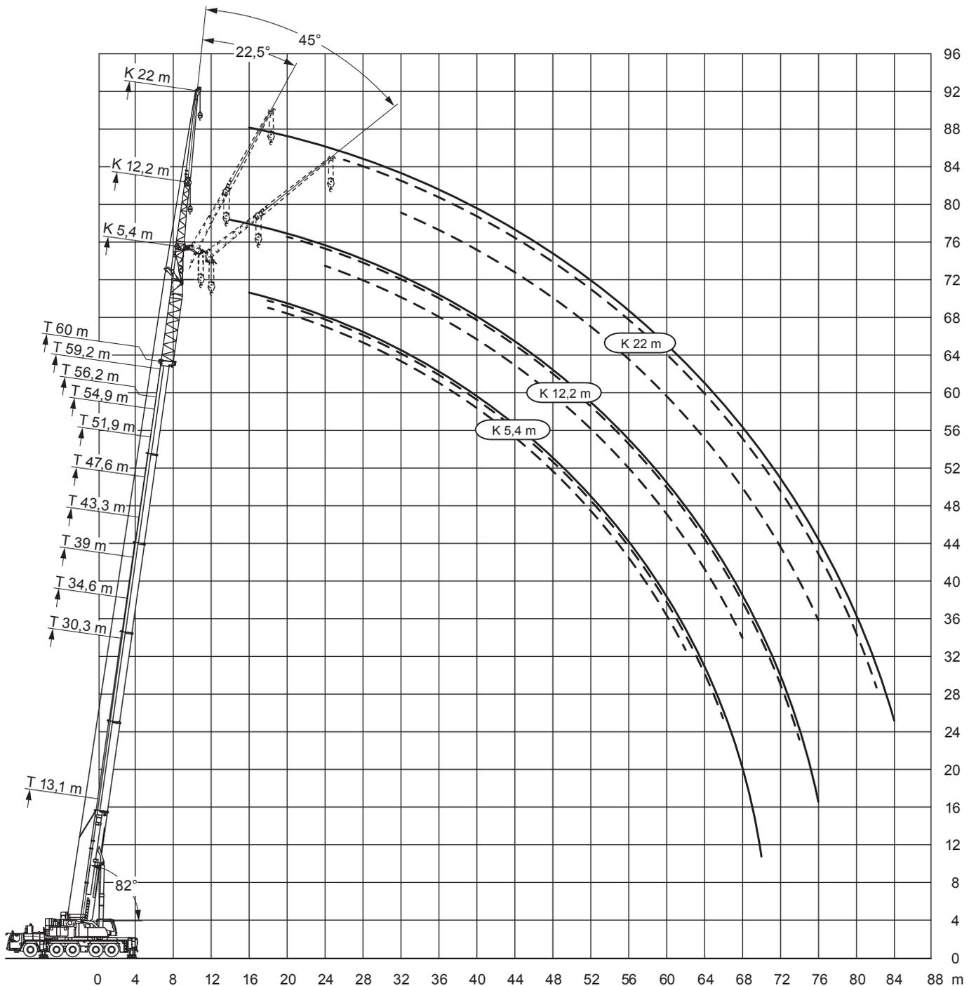
■ Unter Last hydraulisch wippbar
