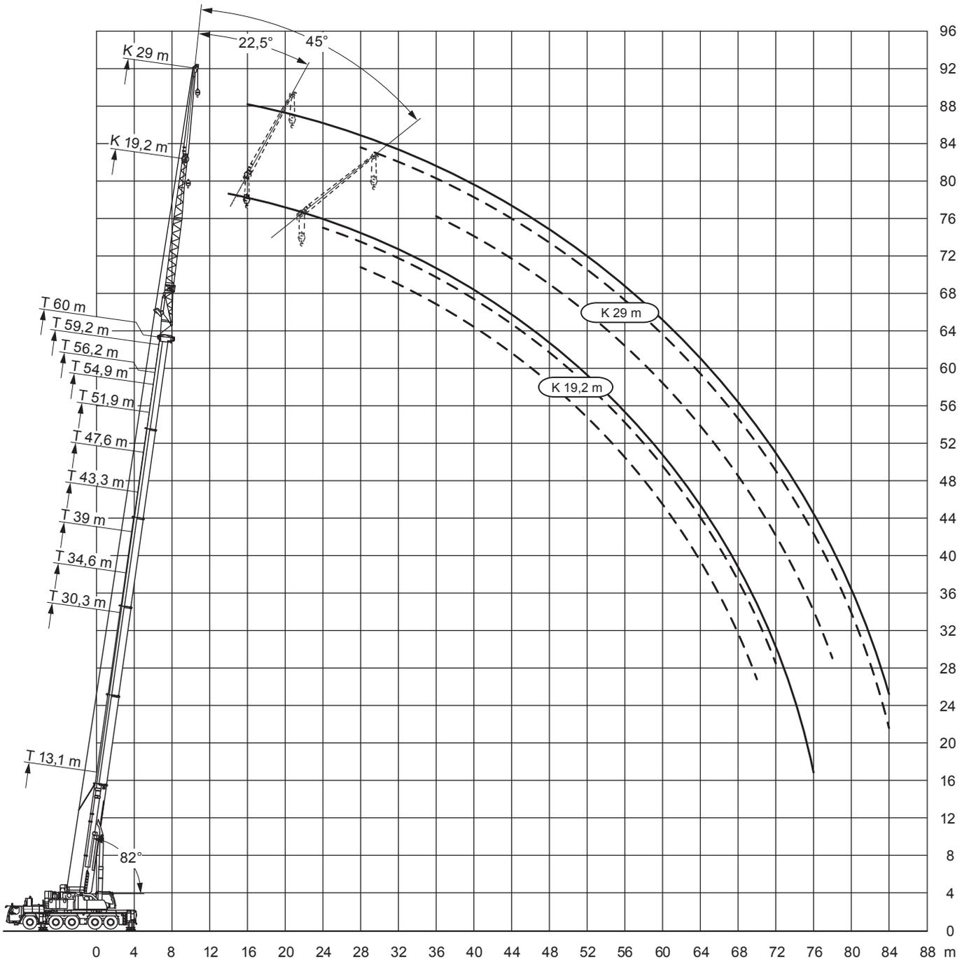
■ Unter Last hydraulisch wippbar
