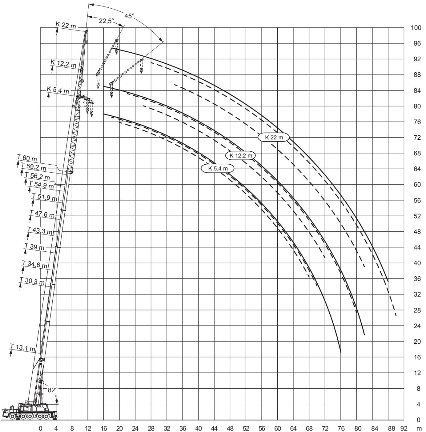
■ Unter Last hydraulisch wippbar
