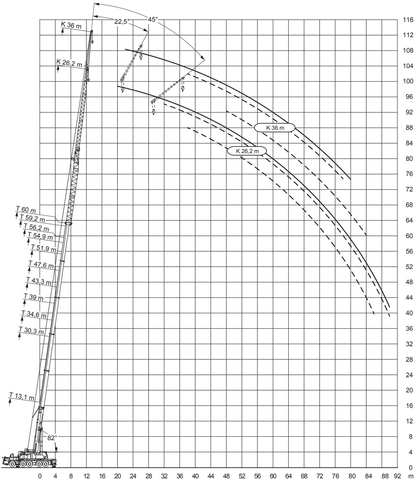
**Unter Last hydraulisch wippbar**
