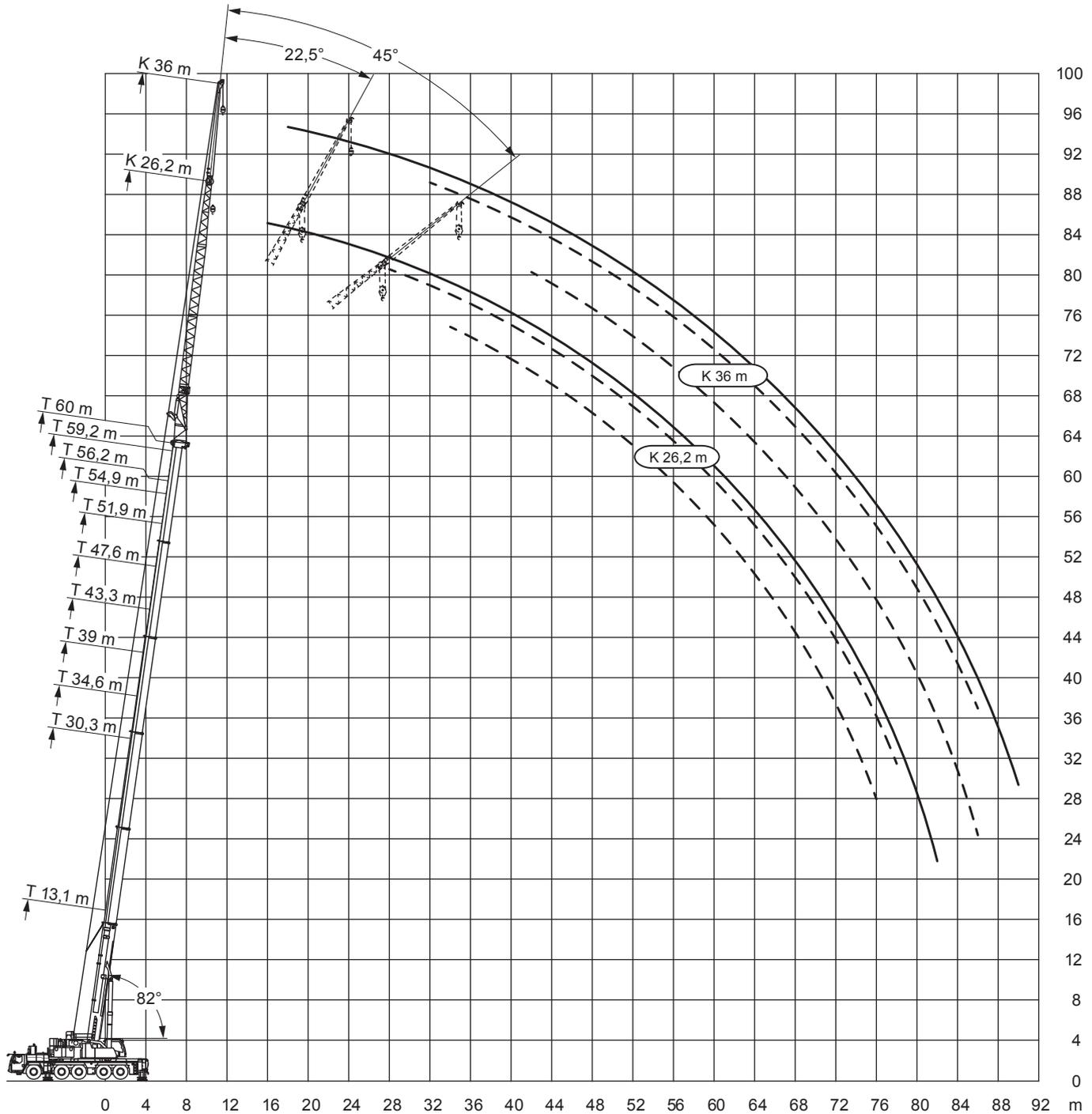
■ Unter Last hydraulisch wippbar
