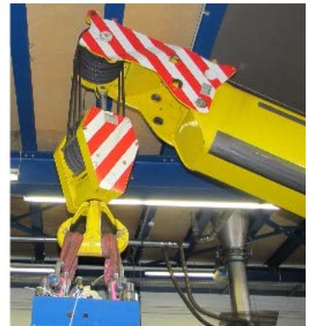
Im Winkel verstellbarer Rollenkopf mit 80 t Lastaufnahme flasche
